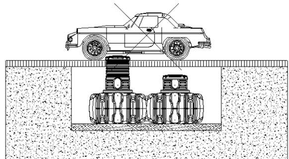
Les cuves ne doivent pas être installées dans une nappe phréatique. Toute infiltration ou tout écoulement doivent le cas échéant être drainés.
