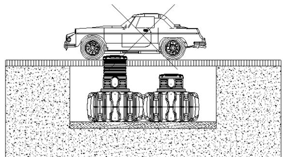
Die Tanks dürfen nicht im Grund-/ Schichtenwasser eingebaut werden. Ist zu erwarten, dass Grund-/Schichtenwasser auch nur gelegentlich auftritt, ist dieses durch eine Drainage abzuleiten.
