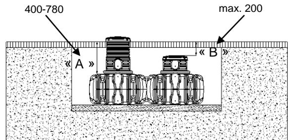
Les cuves ne doivent pas être installées au-dessous d'une zone de circulation.
