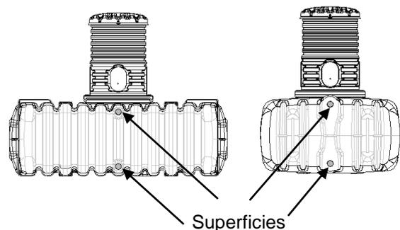
Los depósitos pueden conectarse entre sí en la fosa por el lado longitudinal y/o transversal.
