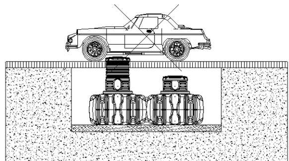
Los depósitos no deben ser instalados en sitios con aguas subterráneas o niveles freáticos altos. Si se espera la aparición de aguas subterráneas de vez en cuando, estas deberán evacuarse por medio de un drenaje.
