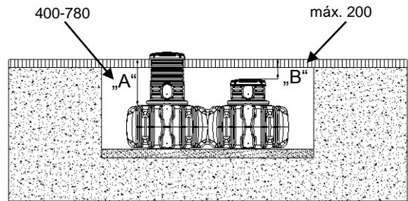
Los depósitos no deben ser instalados bajo zonas de tránsito vehicular.
