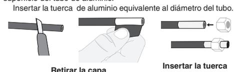
3-) Ajuste de la altura del tubo de aluminio en relación a la base de la brida. El tubo de aluminio HYDRO es más blando (dúctil) que el tubo de cobre, por lo tanto el ajuste de la altura deberá ser evaluado por el instalador, de modo que el área del asiento de la tuerca de aluminio esté toda en contacto con la brida del tubo de aluminio.
