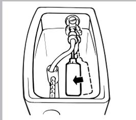
No retire el tamiz colector si la válvula de cierre está abierta.
