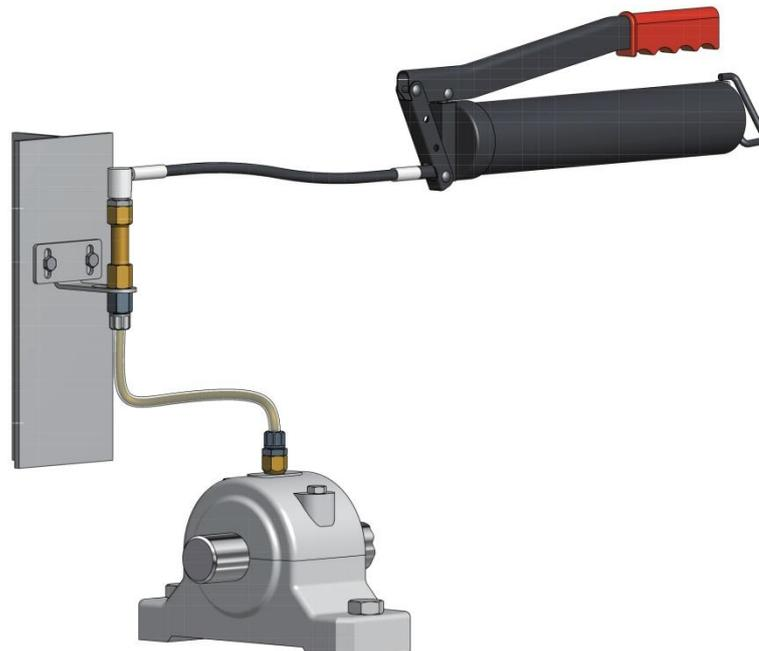
Para la prelubricación y el llenado de las mangueras o tubos, use el adaptador de prellenado.
