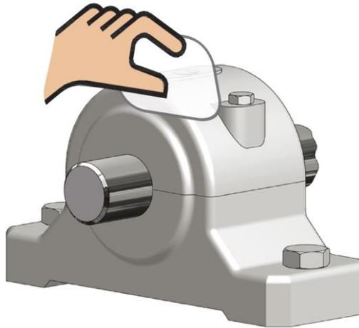
② Retire la boquilla de engrase o el tornillo de cierre de la rosca de conexión y calcule el tamaño de la rosca.
