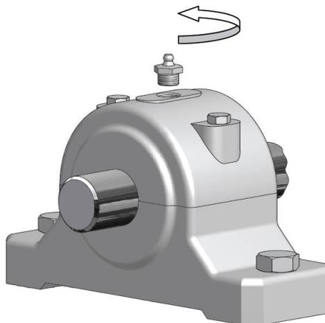
③ Enroscar manguito reductor y, si corresponde, montar los tubos flexibles necesarios.
