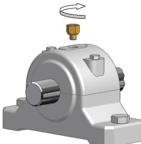
④ Prelubricar el punto de lubricación, todas las conexiones y tubos flexibles.
