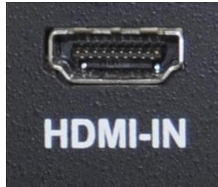
Figura 36: Conector de entrada HDMI
