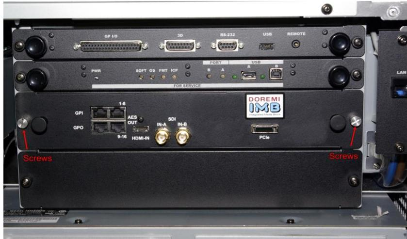
**Figura 10: Instalación del IMB**
