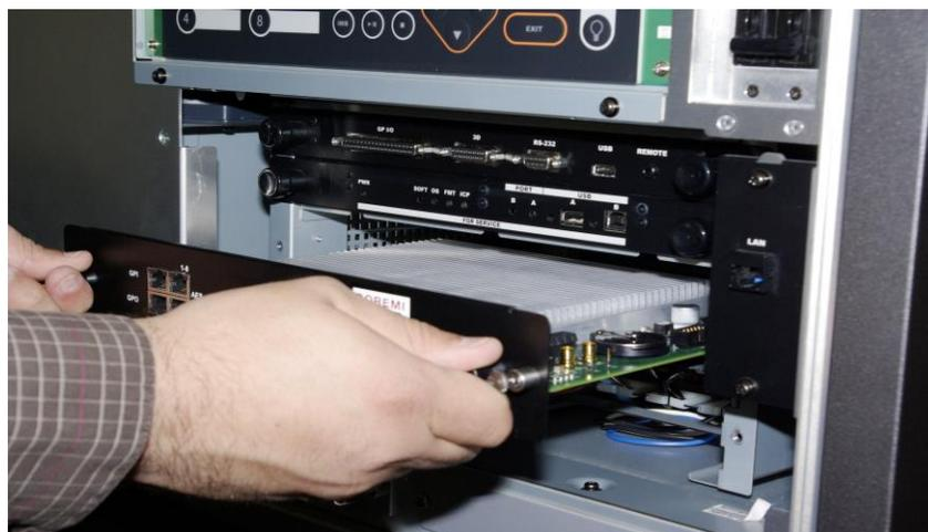
**Figura 9: Instalación del IMB**
