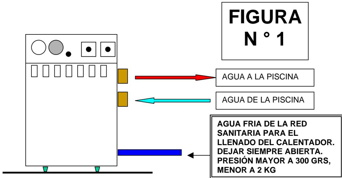
Para realizar el proceso de llenado con agua de red del calentador modelo CAC P se ha dejado una conexión de ½” para tal fin. A esa conexión (identificada en el calentador con un autoadhesivo cuya leyenda dice: “CONEXIÓN PARA LLENADO Y ALIMENTACION PERMANENTE A LA CALDERA”) se la deberá alimentar con una tubería de agua fría de la red sanitaria, la cual deberá quedar siempre abierta. (Fig. N° 1)
