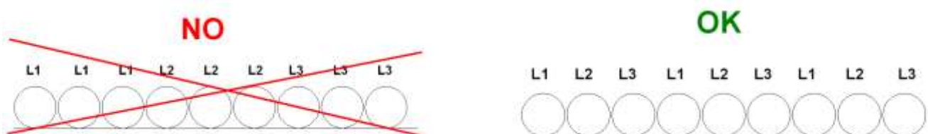
Figura 17 - Instalación de cables largos de energía
