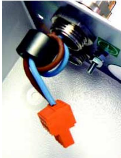
Figura 8: Circuitos de los cables de conexión del relé alrededor de una ferrita de supresión
