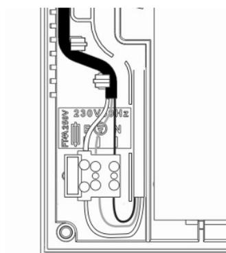
No usar nunca el fusible de la regleta de Red para conectar y desconectar la central de la red, usad el magnetotérmico.
