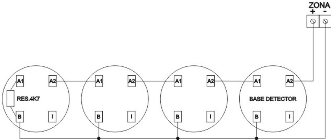
Tal y como se indica en el dibujo anterior, el positivo se conecta en el contacto A2 y la salida por A1, el negativo de entrada y salida se conecta en el contacto B, al final de la línea deberemos colocar una resistencia de 4k7. Recuerde que el número máximo de detectores por línea es de 32 unidades.
