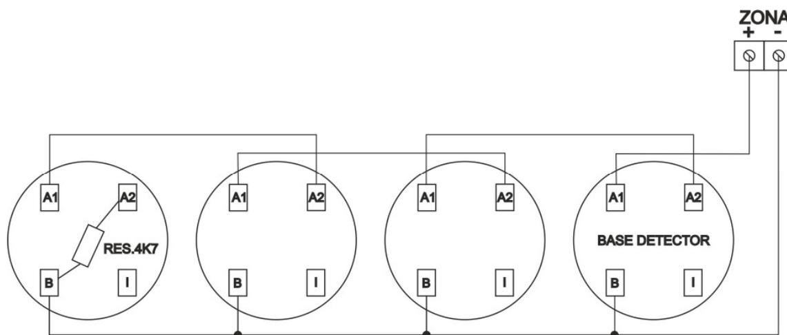
Tal y como se indica en el dibujo anterior, el positivo se conecta en el contacto A1 y la salida por A2, el negativo de entrada y salida se conecta en el contacto B, al final de la línea deberemos colocar una resistencia de 4k7. Recuerde que el número máximo de detectores por línea es de 32 unidades.
