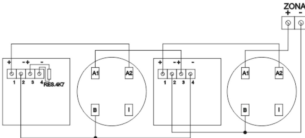
Tal y como se indica en el dibujo anterior, el positivo en el primer dispositivo de la línea se conecta en el contacto A1 y la salida por A2, el negativo de entrada y salida se conecta en el contacto B. El positivo de entrada del siguiente dispositivo se conecta en el contacto + 1 y la salida por el + 3, el negativo de entrada se conecta en el contacto - 2 y la salida se
