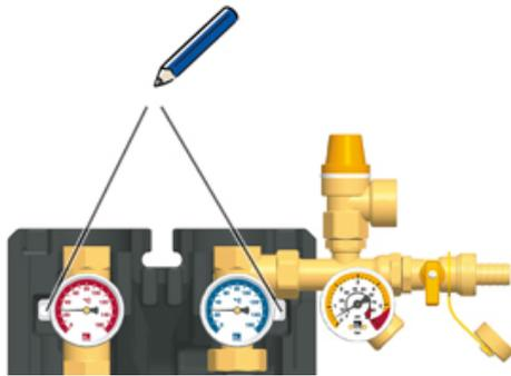
3. Traspase a la superficie de montaje los orificios de fijación contiguos al lado de los termómetros de la estación solar.
