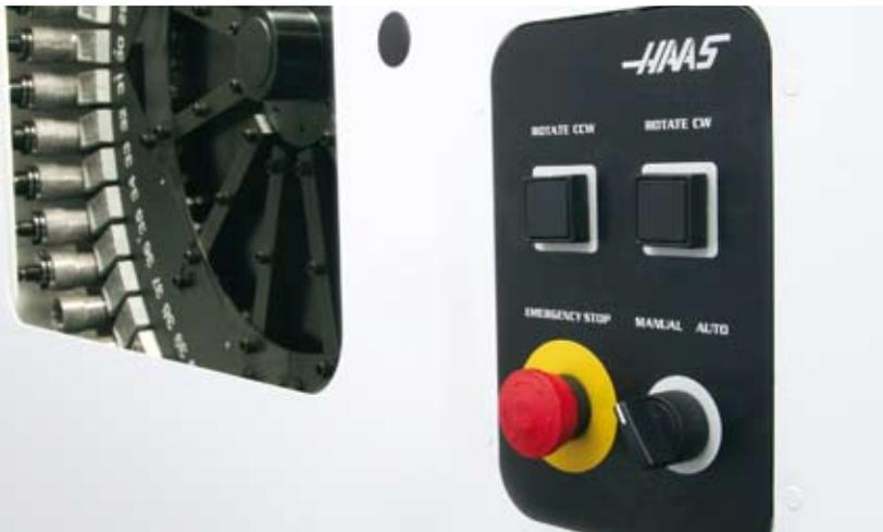
Para simplificar el mantenimiento y la inspección de las herramientas, los CMH de cono ISO 40 de Haas equipados con cambiadores de herramientas de gran capacidad (40 y 70 posiciones) integran una estación de carga de herramientas remota.
