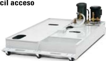
Nuestros depósitos de refrigerante tienen ruedas para facilitar su desmontaje y limpieza. Una cesta de virutas independiente y un filtro de separación evitan que las virutas lleguen a la bomba. Las conexiones eléctricas y las conexiones de los tubos flexibles del depósito pueden retirarse manualmente.
