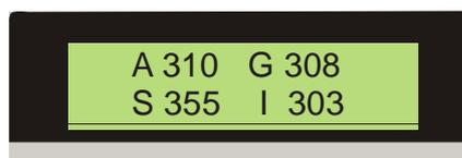
En el ejemplo anterior: al pulsar la tecla ESC, el sistema nos indica que el valor actual es de 310, el valor de flujo SUPERIOR 355 (a partir del cual indicará avería por flujo elevado) y el INFERIOR 303 (avería por flujo bajo). El valor guardado al configurar las ventanas fue 308.
