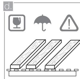
Las piezas que conforman el deck de madera ecológica WPC deben almacenarse en un sitio libre de humedad, en posición horizontal, sobre una estiba, bajo techo y lejos de la luz del sol.
