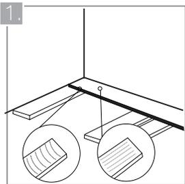
Los listones que conforman el deck tienen una textura diferente a cada lado. Seleccione la que desea que sea la cara vista de la instalación.
