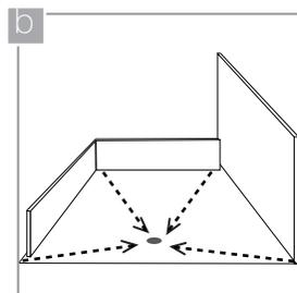
Compruebe que la superficie de soporte cuenta con un declive apropiado para permitir la evacuación de líquidos. Si la colocación es en una terraza, asegúrese de que esta ha sido correctamente impermeabilizada.
