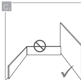
La línea de madera ecológica WPC fue diseñada únicamente para recubrimiento de pisos. Si desea instalar en escaleras, recubra las contrahuellas con los Bordes Deck Escalera (Códigos KM04HO079 y KM04TE078). Por ningún motivo utilice este producto en columnas, vigas, barandas ni en cualquier otro elemento constructivo que soporte cargas.
