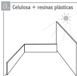
Los pisos WPC consisten en una mezcla de fibras de madera (celulosa) con resinas plásticas. Aunque son resistentes a la intemperie, pueden presentar cambios en sus dimensiones debido a variaciones de humedad y temperatura, así como una decoloración de hasta el 10% debido a la exposición al sol. Todo esto representa un comportamiento natural del producto y no debe afectar su desempeño si se realiza una adecuada instalación.
