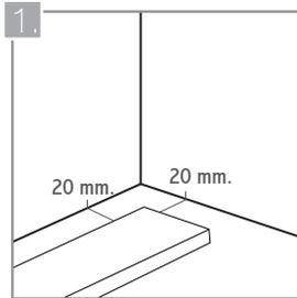
Ubique la primera viga en el mismo sentido del declive del piso, dejando una dilatación de 20 mm. con respecto a las paredes.
