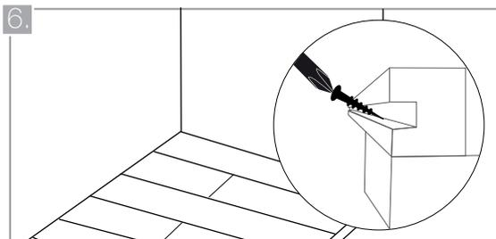
La última línea de piezas debe prolongarse un centímetro sobre las vigas transversales, manteniendo una junta perimetral de 5 mm. con respecto a la pared en los casos en los que aplique. Fíjelas en su posición insertando clavos galvanizados en ángulo de 45° por sus cantos.
