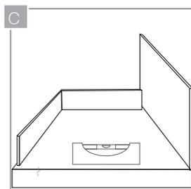
La superficie de soporte debe estar totalmente curada, limpia y seca. Cualquier diferencia mayor a los 5 mm. por metro lineal debe corregirse con mortero.
