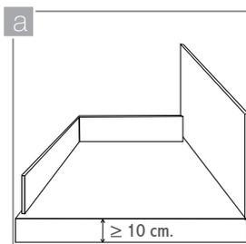
Verifique que la superficie de soporte sea lo suficientemente rígida y estable. No debe presentar oscilaciones. Se recomienda un espesor mínimo de 10 cm para resistir las perforaciones.
