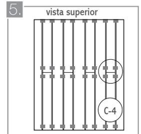
Continúe con este procedimiento hasta recubrir todo el ambiente. En los casos en los que se requiera cortar los listones, póngalos con la cara vista hacia abajo si utiliza serrucho, y hacia arriba si utiliza una sierra circular
