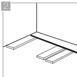
Coloque el primer listón de madera ecológica WPC en el mismo sentido de las vigas transversales y con una dilatación de 5 mm con respecto a las paredes. Debe ser tan largo como sea posible para brindar soporte a las piezas siguientes.
