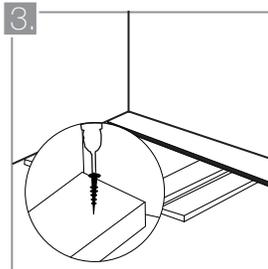
Marque con lápiz el punto en que la pieza de madera se encuentra con el centro de la primera viga, realice una perforación y fije con un tornillo de cabeza plana. Repita en todos los puntos donde la pieza se encuentre con los soportes.
