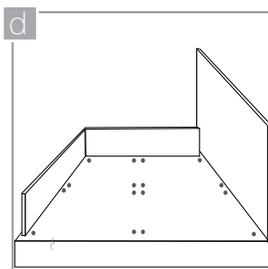
Realice una modulación del área a instalar en la que determine las juntas perimetrales, las posición de las vigas y los puntos de perforación. Defina la posición de elementos excesivamente pesados como hidromasajes, materas de gran tamaño o fogones, ya que en estos puntos se requerirá de vigas de refuerzo adicionales.
