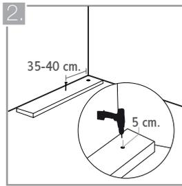
Perfore la viga a 5 centímetros desde su punto de inicio y a partir de allí a intervalos regulares cada 35 o 40 centímetros. Realice el anclaje mediante chazos. Si requiere de vigas adicionales, deje un espacio de 5 mm. entre ellas. Verifique constantemente su alineación.
