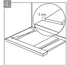
Remate el espacio entre las vigas longitudinales con vigas transversales, dejando un espacio de 5 mm. entre unas y otras.
