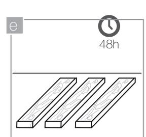
Extienda las piezas de madera ecológica WPC en el sitio de instalación durante las 48 horas previas con el fin de que su nivel de humedad se equipare con el del ambiente.
