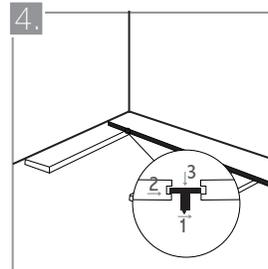
Inserte uno de los brazos del perfil tipo C-4 en el lado acanalado del listón de madera y atornillelo en la viga longitudinal. Repita el proceso con el listón siguiente, dejando un espacio de 5 mm entre pieza y pieza.
