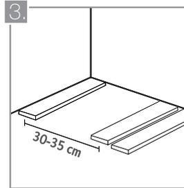
Con excepción de la primera y la última fila, las vigas longitudinales deben instalarse en pares, distribuidos uniformemente cada 30 o 35 cm., respetando las juntas perimetrales y dejando un espacio de 5 mm. entre una y otra.
