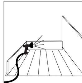
Si lo desea, puede utilizar una manguera de jardín convencional para la limpieza profunda. Las mangueras a alta presión deben tener una presión máxima de 1200 PSI, ya que de lo contrario podrían arañar e incluso agrietar la superficie de las piezas.
