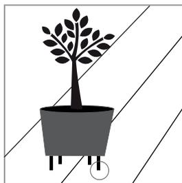
No hay un tratamiento específico para tratar las manchas generadas por corrosión. Verifique que todos los elementos utilizados en la instalación sean inoxidable. Preste especial atención a los soportes y parrillas de las materas.
