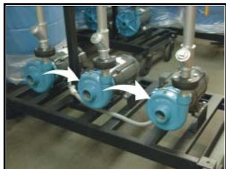
mínima de arranque calibrada de la segunda motobomba, la motobomba arranca para que trabaje en conjunto a la bomba que ya esta operando. Si el equipo tiene más de dos bombas y la presión sigue bajando el **simultaneado** se sigue dando en las otras motobombas del equipo.
