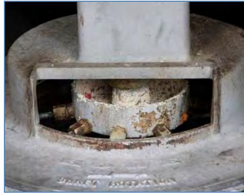
Los efectos de las cascarillas y el sedimento pueden ser muy destructivos para la máquina para hacer hielo en escamas.
