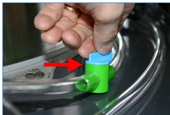
5. Abra la válvula de detención de la máquina para hacer hielo en escamas para permitir que el agua salga del sumidero de agua. Luego, cierre la válvula de detención para evitar pérdidas de solución.
