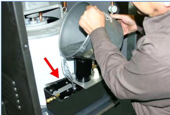
10. Llene el sumidero de agua con agua corriente. Prenda el interruptor de energía (On) durante 2 a 3 segundos y luego vuelva a apagarlo (Off) en el panel de control de la máquina para hacer hielo en escamas. Esto purgará la solución de limpieza de la máquina para hacer hielo en escamas mientras se está drenando
