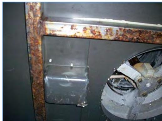
Si no se quita del agua, el cloro se mezcla con la humedad presente en la máquina para hacer hielo en escamas y el cubo para hielo, para formar un ácido levemente clorhídrico. Este ácido puede provocar que se forme óxido en las superficies del acero inoxidable, en uno o dos años.
