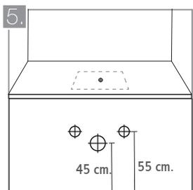
Compruebe que haya una altura de 45 cm. desde el piso terminado hasta el eje del sifón y de 55 cm. desde el piso terminado hasta el eje de los abastos de agua fría y caliente.
