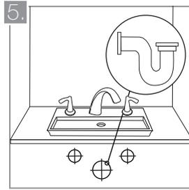
5. Conecte la trampa P al extremo del sifón y la boca del desagüe. Deje que el pegamento fragüe durante el tiempo especificado por su fabricante.
