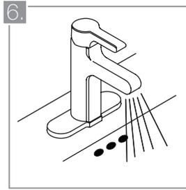
6. Abra las llaves de paso y las griferías. Compruebe que el agua es evacuada eficientemente, que el sifón ha sido correctamente instalado y que el rebosadero (si lo hay) evacua el exceso de agua correctamente.
