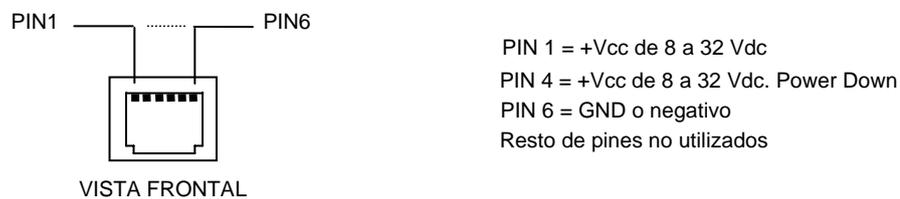
**Figura 12. Conector de alimentación terminales telefónicos MC35i y TC65T.**
