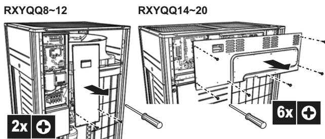
Para fines de mantenimiento, se debe acceder a los pulsadores de la PCB principal. Para acceder a estos pulsadores, no es necesario abrir la cubierta de la caja de componentes eléctricos. Consulte "13. Realización de ajustes de campo" en la página 30.
