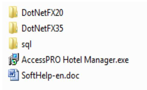
Haga doble clic en el archivo AccessPRO Hotel Manager.exe, y el sistema pedirá la instalación de dos software. Net Framework y SQL. Son la herramienta que necesita el softwares. Sólo se tiene que seguir las instrucciones y hacer clic <Siguiete>. Si se encuentran instalados en el ordenador, el proceso de instalación se saltará automáticamente. Por último, el sistema pedirá instalación de AccessPRO Hotel Manager
