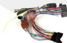
Cableado de conexión Quadlock del módulo de voz
