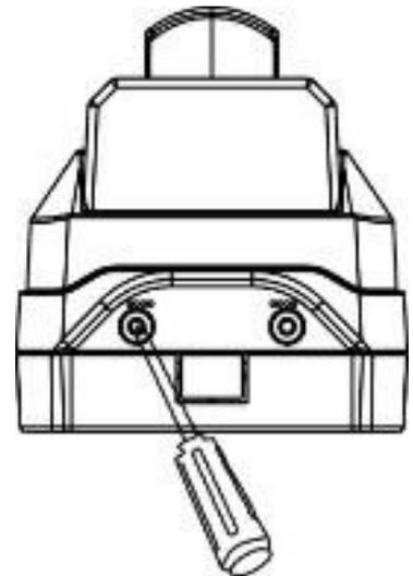
2.- Remueva los tornillos de la parte de abajo del equipo.
