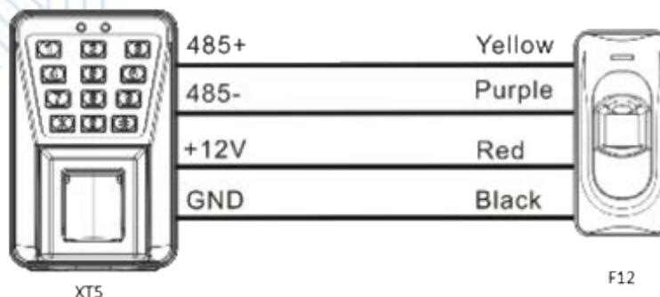
La integración del lector F12 permite utilizar la función anti-passback en el XT5, siendo esta funcional, únicamente entre el XT5 maestro y su respectivo F12 esclavo.
