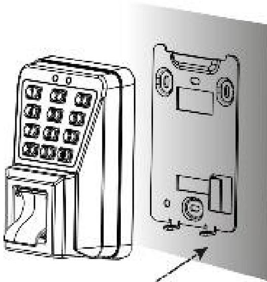
5.-Ensamble el equipo en la placa que ya esta instalada en la pared.
