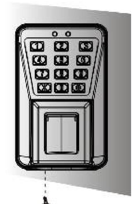
6.-Por último, coloque los tornillos de la parte inferior del equipo.
