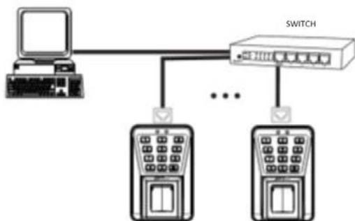
2.- Conexión a través de una red ya estructurada. En este caso la PC ya cuenta con dirección IP asignada por DHCP, y mediante software se asignan direcciones IP a los dispositivos biométricos dentro del mismo rango del DHCP.
