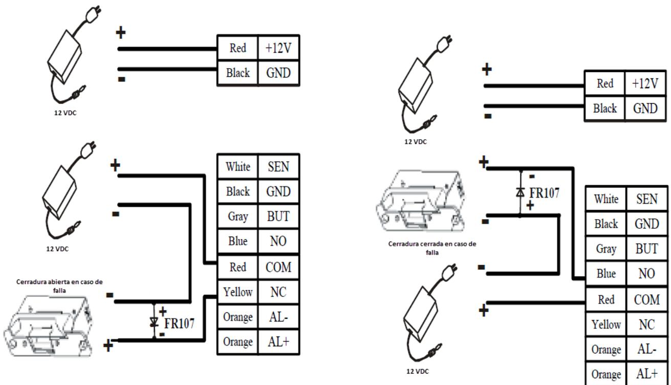
El XT5 posee una salida de alarma que puede ser utilizada para activar una sirena o dispositivo que sirva para alertar sobre algún evento como sabotaje al control de acceso.
