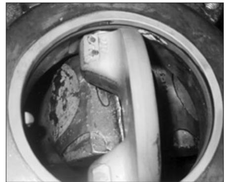
Figura 1 - Válvula fijada correctamente en su lugar.
