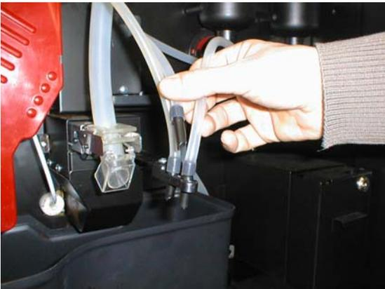
Extraiga los tubos de silicón de salida del producto y los soportes de los tubos de erogación del producto. Sumerja todo en la solución.
