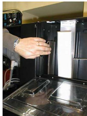
empuje hacia el exterior las dos paredes móviles hasta bloquearlas: base deslizante
