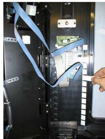
Introduzca las etiquetas en las ranuras siguiendo el esquema indicado en la Hoja de Memoria, también adjunta al manual. Desde el exterior del distribuidor controle que estén colocadas correctamente.
