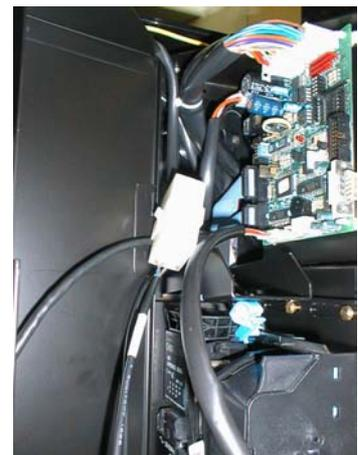
Conecte a la ficha CPU el cableo de diálogo (en el caso de sistemas de estándar Executive el cableado está en dotación con el distribuidor; en el caso de otros sistemas, el cableado está en dotación con el sistema de pago).
