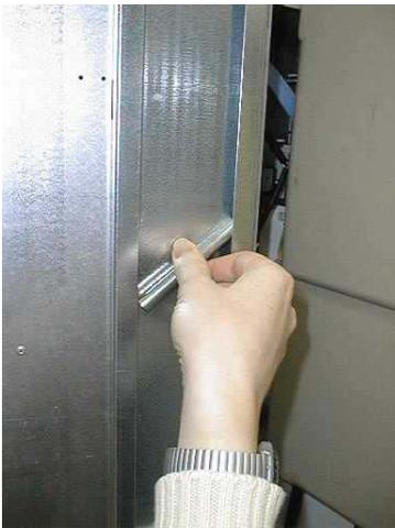
Con el distribuidor abierto y apagado, desbloquee y extraiga el peso de metal.
