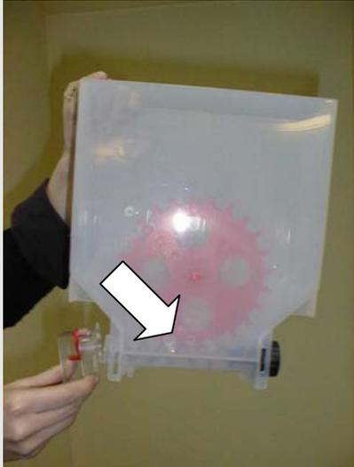
2) El motorreductor acciona el tornillo si fin del envase del producto correspondiente el cual vierte en la licuadora la cantidad preestablecida de producto. Pueden actuar simultáneamente varios contenedores en la misma licuadora;
