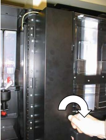
Extraiga la protección de la ficha CPU destornillando los tornillos de bloqueo.
