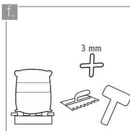
Asegúrese de que cuenta con los siguientes elementos antes de iniciar la instalación: mortero de pega y material de boquilla, cruces plásticas de al menos 3 a 6 mm. de espesor, llana dentada de 6 a 12 mm. (según el formato) para la aplicación del mortero, espátula de goma para el emboquillado y cartón corrugado.
