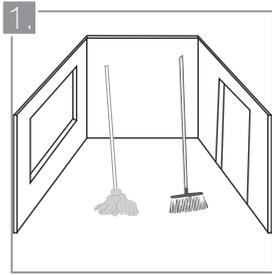
1. Antes de iniciar la instalación, barra y trapee el piso para eliminar el polvo y los residuos de obra, ya que estos restan adherencia al mortero de pega.
