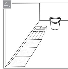
4. Esparza mortero de pega sobre un área equivalente a la de la pieza y cree surcos con la llana dentada. En formatos superiores a los 33 x 33 cms., repita el procedimiento en la cara oculta de la pieza. Adhiera la pizarra inmediatamente, ya que la exposición del pegamento al ambiente puede restar sus propiedades de adherencia.
