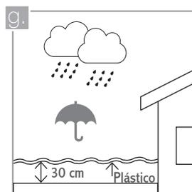
Si el trabajo es en exteriores, recubra la superficie instalada con polietileno durante la noche o en los paros de colocación para prevenir que las piezas se mojen en caso de lluvia. Es importante dejar un espacio de 30 cm. entre las piezas y el plástico para permitir la evaporación de la humedad presente en el pegamento.
