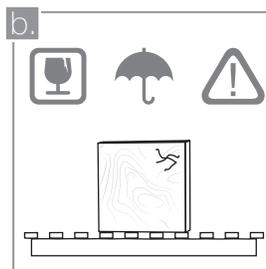
Las pizarras requieren de un manejo cuidadoso durante su almacenamiento, manipulación e instalación para evitar ruptura, astillado en los bordes o rayado de la superficie. Almacene las piezas bajo techo, sobre una estiba y siempre en posición vertical.
