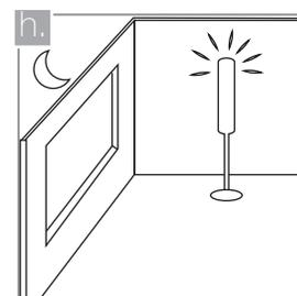
Si la instalación es en interiores o durante la noche, ilumine el área de trabajo hasta obtener condiciones de luz superiores a las que tendrá el ambiente finalizado. Así detectará errores de colocación con facilidad.
