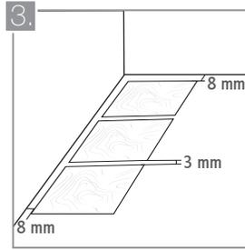
3. Mantenga una distancia mínima de 3 mm. entre las piezas y una junta perimetral de 8 mm. con respecto a los muros para prevenir un desprendimiento futuro del producto. En áreas extensas, instale los pisos en secciones de máximo 25 m<sup>2</sup>, dejando dilataciones perimetrales de 8 mm. entre ellas. Si la superficie tiene juntas estructurales debe respetarlas. Recomendamos el uso de Sikaflex 1A o 1CSL para el llenado de estos espacios.
