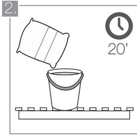
2. Prepare una cantidad de mortero de pega suficiente como para veinte minutos (20') de trabajo y déjela reposar por diez minutos (10') antes de iniciar su aplicación. No añada arena, retenedores de agua, látex, carbonato de calcio o cal a la mezcla. No combine una mezcla recién hecha con una ya reposada, pues esto reducirá su adherencia.
