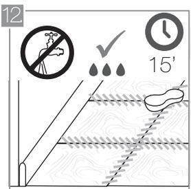
12. Retire los excesos de boquilla con una esponja humedecida en agua limpia antes de que se cumplan 15 minutos de su aplicación. No omita este paso, pues el contacto prolongado con el material de rejuntado ocasiona daños irreparables en la superficie de las piezas.
