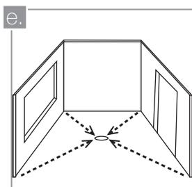
Verifique que el área a recubrir está completamente seca, uniforme y con el declive necesario para el drenaje de líquidos. Es obligatorio realizar un proceso de impermeabilización para prevenir fenómenos de eflorescencia, que no se considerarán fallo del producto ni del pegante utilizado para su adherencia.
