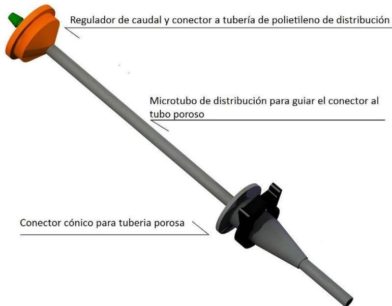
El dispositivo consta de tres componentes; una base que sirve de anclaje a la tubería de polietileno (baja densidad) y de regulador de caudal al mismo tiempo, a este dispositivo también se le llama gotero de botón. Una conexión cónica diseñada para conectar la tubería porosa al micro regulador, y un micro tubo de alimentación que sirve de guía para ajustar las instalaciones.
