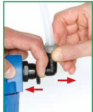
3. Apretar el soporte con ayuda de la herramienta para aflojar para aflojar en dirección al empalme enroscable 1/2" (OUT), sujetar y sacar totalmente el ángulo de conexión.\*
