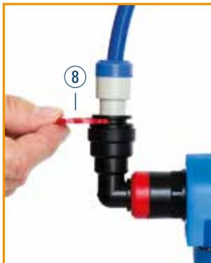
4. Meter la junta de seguridad (8) entre la ranura que está entre el elemento de sujeción y la pieza de conexión.
