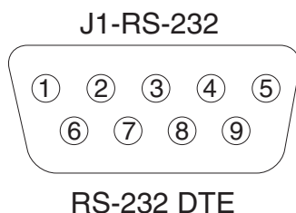
Figura 24. Designación de clavijas del puerto de comunicaciones RS-232 del tablero trasero.
