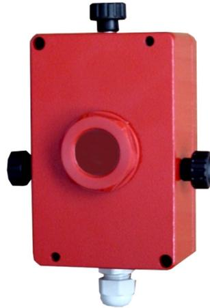
El sensor detector de chispas se utiliza en el ducto que lleva el polvo hacia el colector de polvos y/o en todos los ductos en los cuales transita polvo a diferentes equipos, como silos. Prácticamente es parte de un sistema contra incendio. En este sensor se instaló un sensor especial, muy sensible a la luz, y en especial al ultra violeta e infrarrojo.
