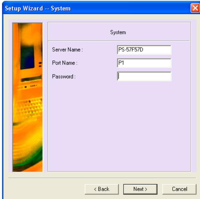
U kunt hier de Print Server een naam binnen uw netwerk geven. Deze kunt u invoeren bij "Server Name". De "Port Name" is voor de naam van de USB poort op de Print Server.
