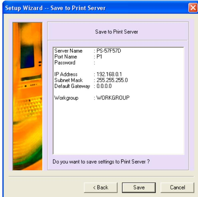
Para guardar sus ajustes, presione "**Save**". Para realizar cambios, presione "**Back**", o bien presione "**Cancel**" para abandonar la configuración.
