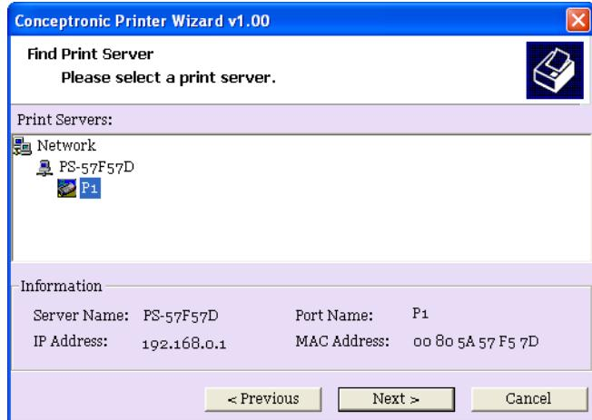
Il programma cercherà il Print Server nella rete in uso, e una volta rilevato, lo mostrerà nella sezione "Network" (Reti)..
