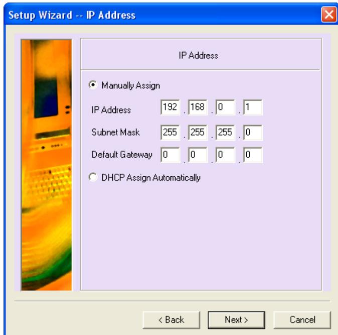
Se necessario, è possibile modificare l'indirizzo IP e la Subnet Mask del Print Server. È anche possibile impostare la configurazione su "DHCP Assign Automatically" (Assegnazione automatica del DHCP) nel caso in cui si disponga di server DHCP nella rete.
