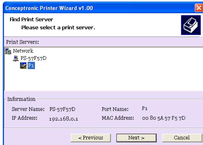
Het programma zal zoeken naar uw Print Server binnen uw netwerk. Als deze gevonden wordt zal deze weergegeven worden onder "Network".
