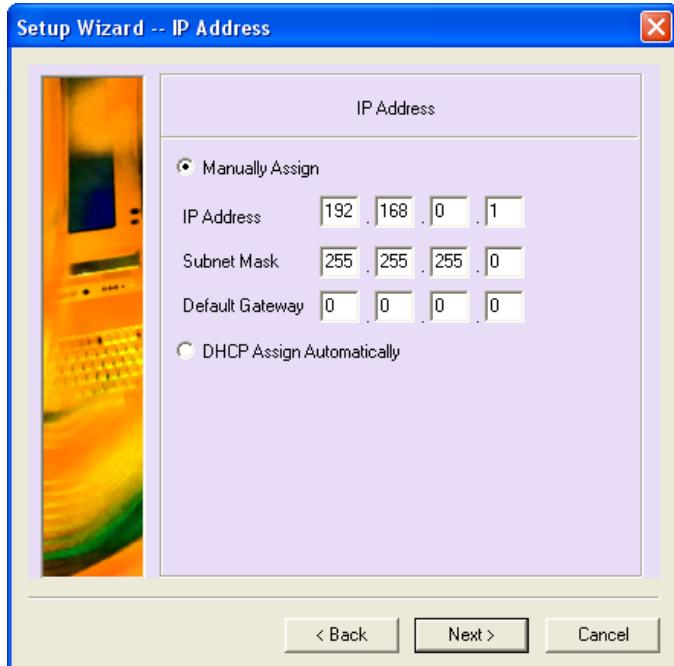
Cuando sea necesario, usted puede modificar la dirección IP y la Máscara de Subred de su Servidor de Impresión. También puede determinar la configuración de “DHCP Assign Automatically” si posee un servidor DHCP en su red.
