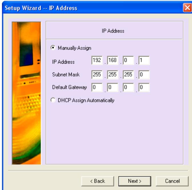
Se necessário, pode alterar o endereço IP e a Máscara Subnet do seu Servidor de Impressão. Também pode definir a configuração para "DHCP Assign Automatically", se tiver um servidor DHCP na sua rede.
