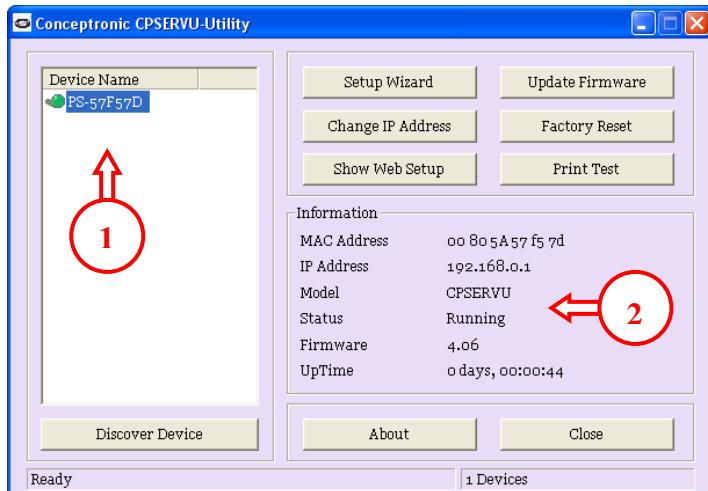
A la izquierda (1), puede ver los dispositivos descubiertos en su red. A la derecha (2), ve la información del Servidor de Impresión seleccionado.
