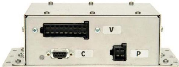
Figura: Conexiones en el analizador por el lado del vehículo
