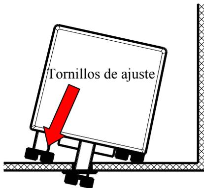
Cada uno de los sensores se ajusta apretando o aflojando el tornillo de ajuste correspondiente. El sensor se inclina más o menos según la profundidad a la que llegue el tornillo. Proceda a alinear el sensor de manera que el límite de su cortina externa coincida con el canto de la puerta.
