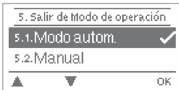
Bajo el menú “5. Modo de funcionamiento” el regulador se puede apagar, operar en automático u operar en manual.
