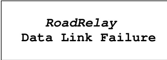
Esta pantalla indica que el RoadRelay™ no ha recibido ningún dato del motor, durante los últimos 30 segundos. Esta falla indica que algo está mal con los componentes electrónicos del motor, el cableado hacia el RoadRelay™, o posiblemente el mismo RoadRelay™. Revise que todos los cables estén conectados correctamente y que los componentes electrónicos del motor tengan energía.
