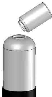
Pour the new media into the tank.
