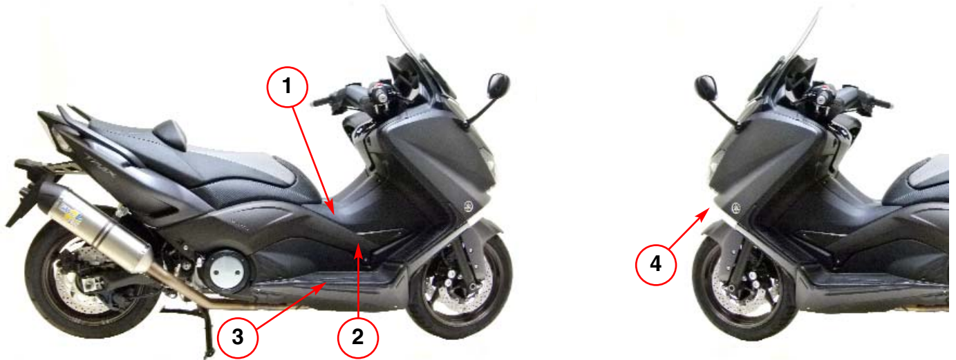
1) Inyectores | 2) Masa | 3) TPS (sensor posición mariposa) | 4) Señal de Revoluciones
