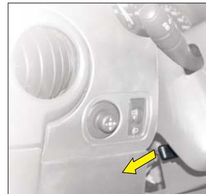
Ajustar la altura del volante y bloquearlo tirando a fondo de la palanca de mando.
