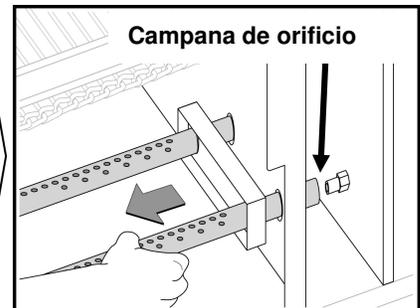
la cámara. Limpie, vacíe el agua que quede en el quemador y vuelva a colocarlo. **¡Seque completamente todos los orificios de los quemadores!**
