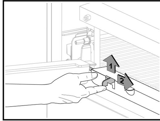
Levante y deslice el perno de retención hacia la derecha.
