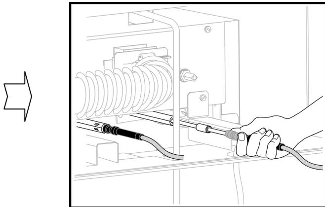
Con el asador enfriado, quite el sensor tirando de la cubierta negra ubicada junto a la cerámica según se muestra.
