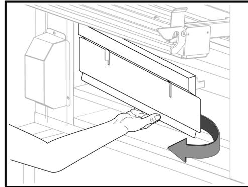
Gire el lado derecho del panel hacia afuera según se muestra. Limpie y coloque aparte.
