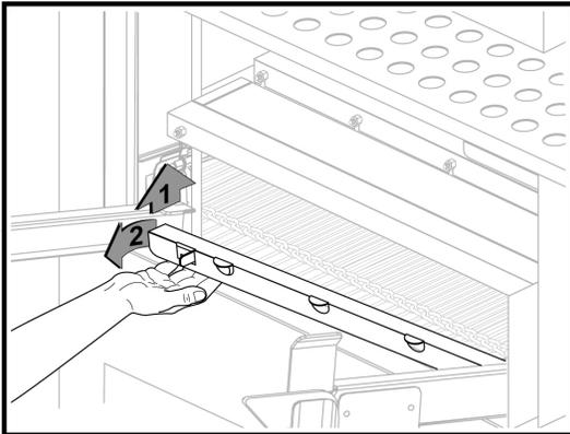
Levante un poco y quite la rampa del cargador según se muestra.
