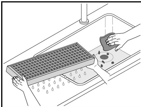
*Quite el catalizador y agítelo para eliminar el exceso de agua. Vacíe y limpie el lavabo completamente y después repita el paso 3.*
