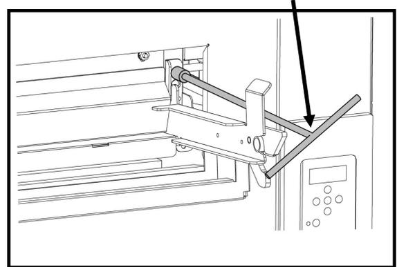
Instale el soporte del cargador con (4) tuercas de 1/4-20. Use la herramienta de alargamiento suministrada para quitar y volver a instalar las tuercas. (Las tuercas se envían instaladas en los espárragos de montaje del cargador).
