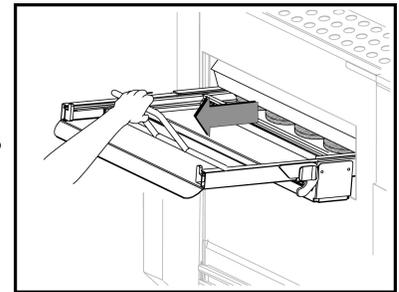
Tire del cargador hacia afuera con el asa girada.
