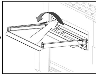
Gire el asa hacia abajo para levantar la barra interior sobre el producto.
