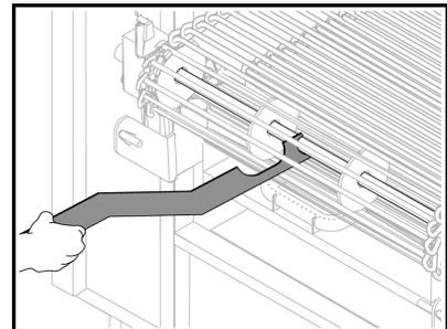
Use el extremo de la herramienta para limpiar el eje de descarga del transportador.
