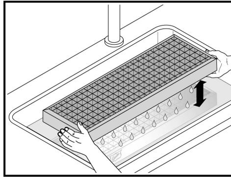
*Llene parcialmente un lavabo suficientemente grande para adaptar el catalizador con suficiente agua caliente (100 a 130°F) para tapar completamente el catalizador al colocarlo en el lavabo. Agite el catalizador hacia arriba y hacia abajo en el agua varias veces y después deje que se empape durante 20 minutos.*
