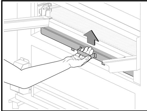
Levante el apaga llamas para desenganchar las lengüetas de las ranuras. Las lengüetas están ubicadas debajo de la parte delantera del apaga llamas.
