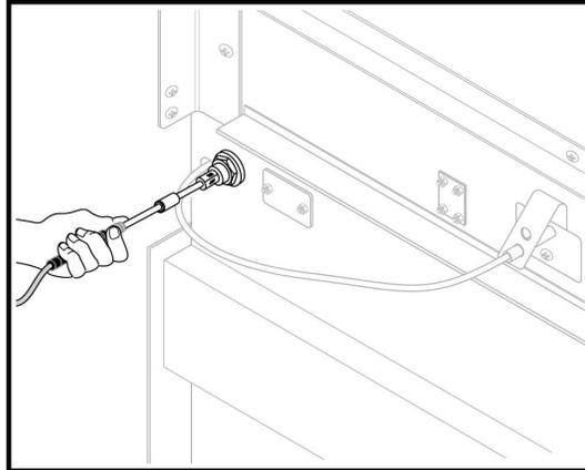
Con el asador enfriado, quite el panel trasero del asador y quite el sensor para el quemador inferior. Siga los mismos procedimientos que para los sensores superiores.
