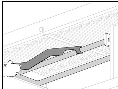
Para una acumulación grande, use el extremo del raspador de la "Herramienta de limpieza del tubo del quemador".
