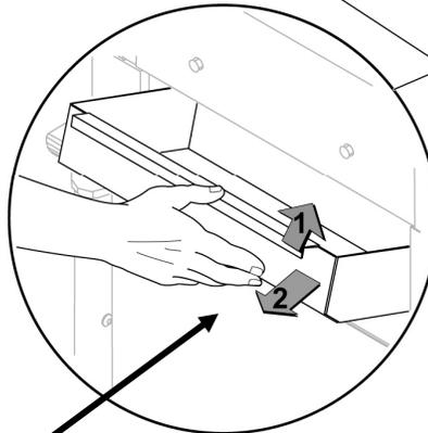
**Colector de grasa de descarga:** Incline hacia arriba para desenganchar y tire hacia adelante para retirarlo. Limpie el colector y el área y vuelva a colocarlo.
