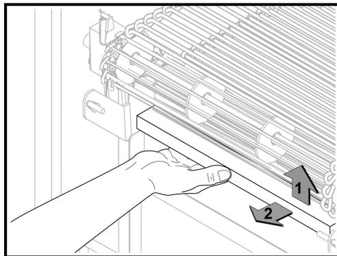
**Raspador de descarga:** Levántelo y tire hacia adelante.
