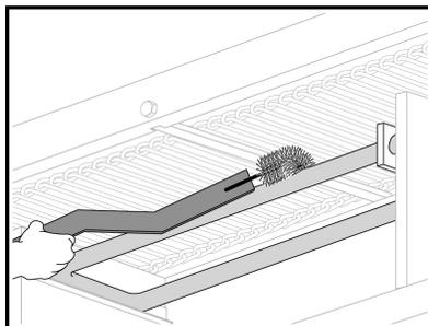
Limpie la parte superior del quemador con el extremo del cepillo de la "herramienta de limpieza de tubos de quemador".
