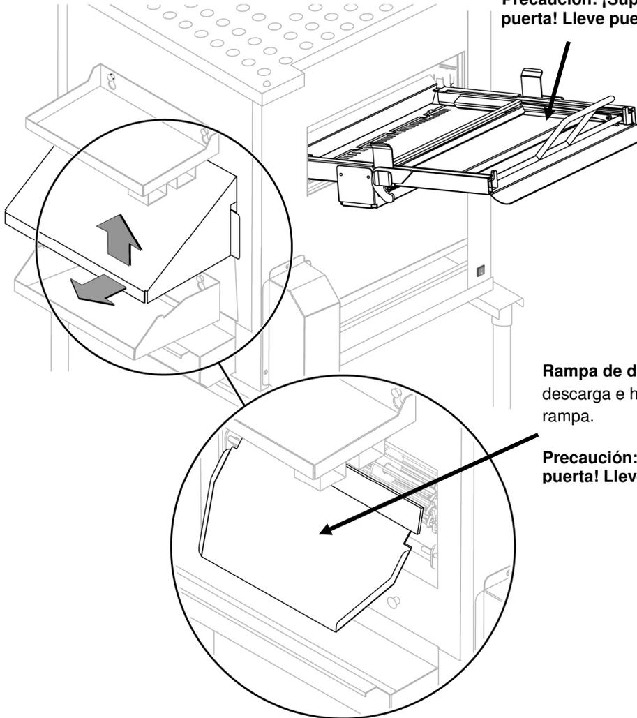
**Rampa de descarga:** Quite la campana de descarga e higienice la superficie exterior de la rampa.
