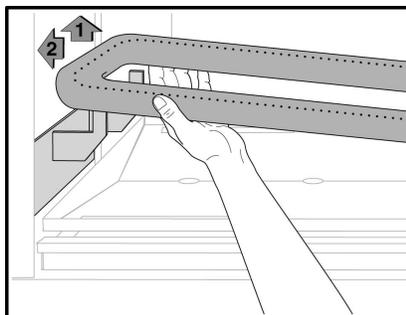
Levante la parte trasera del quemador del asiento y siga sujetándola.
