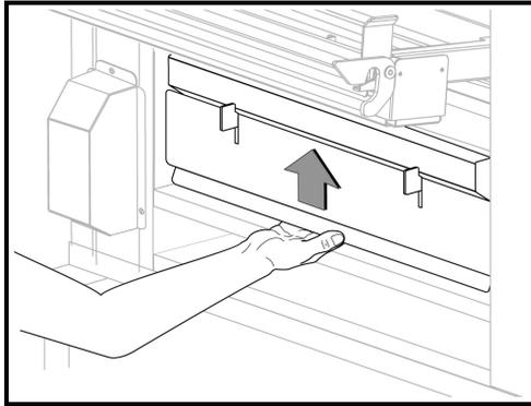
Con el panel delantero exterior quitado. Levante el panel de la cámara de combustión.
