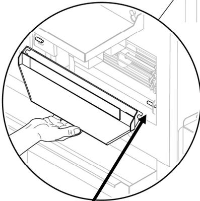
**Conecte los ganchos en el pasador para volver a instalar la rampa**
