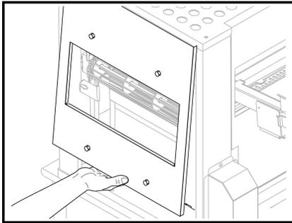
**Panel del extremo de descarga:** Quite los accesorios de descarga y levante el panel mientras se gira hacia afuera y hacia abajo.
