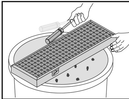
*Golpee ligeramente el bastidor del catalizador mientras lo sujeta sobre una tolva de desechos para desprender cualquier partícula de ceniza/carbón suelta.*
