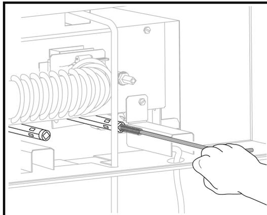
Después de quitar el sensor, tome la barra de limpieza con asa en forma de te y pase el cepillo con cuidado por el tubo del sensor de llamas. Empuje y pase el cepillo por cada tubo varias veces para asegurarse de que esté limpio.
