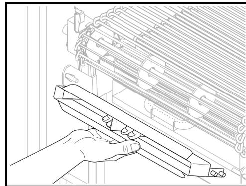
**Raspador de descarga:** Tire de los pasadores guía de las ranuras. Limpie el raspador y el área. Reemplácelo
