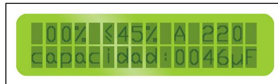
Pulsando nuevamente la tecla de “↑” desde la opción de temperatura (o “↓” desde la tensión) se llega a la opción de condensador necesario para corregir la reactiva. Aparece entonces “capacidad:xxxxµF” indicando la capacidad en microfaradios del condensador a la salida del regulador que sería necesario para compensar el factor de potencia hasta 0.99i.
