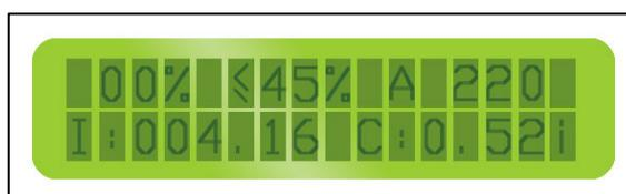
Pulsando la tecla de “↑” desde la opción de las tensiones la línea inferior del display cambia para mostrar “I:xxx.xx C:x.xxx”. La I indica la intensidad actual en amperios, y la C indica el factor de potencia. A la derecha de éste último aparece una letra, que puede ser i si el factor de potencia es inductivo, o c si es capacitivo.
