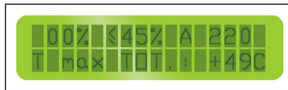
Con una nueva pulsación de la tecla de “↑” aparece en la parte inferior del display información sobre la máxima temperatura que se alcanzó desde que se encendió por primera vez la máquina.
