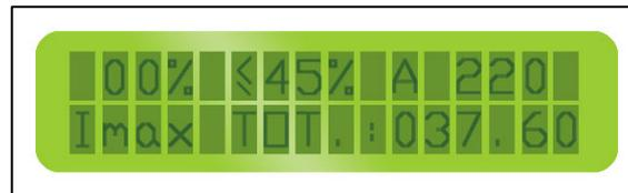
Con una nueva pulsación de la tecla de “↑” aparece en la parte inferior del display información sobre la máxima intensidad que se alcanzó desde que se encendió por primera vez la máquina.
