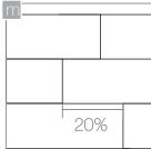
Realice la instalación de manera tal que la línea entre las piezas forme una cuadrícula. Si desea colocar los productos en un patrón escalodo de 'junta trabada', hágalo de manera tal que la intersección entre las fichas no supere el 20% del lado total de la pieza.
