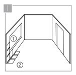
Instale primero las paredes y luego los pisos. Esto contribuirá a evitar desniveles que se forman al ejercer presión sobre las piezas antes de que se complete el tiempo de fraguado.
