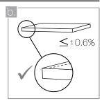
Las normas técnicas establecen que los lados de una pieza pueden tener una diferencia de ±0.6% con respecto a la diagonal del formato establecido por la casa matriz. Esta es una característica de fabricación y se pueden corregir manteniendo una junta de 3 mm. entre pieza y pieza. No es recomendable combinar dos productos del mismo tamaño, pero de dos marcas diferentes, ya que pueden presentarse diferencias dimensionales muy notorias.
