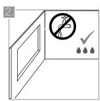
Sature de agua la superficie sobre la que instalará el gres porcelánico, de manera tal que permanezca húmeda durante la colocación.
