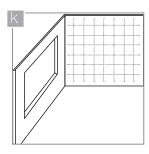
Realice una modulación del área a recubrir para determinar los ejes de inicio y terminación. Si es necesario cortar algunas de las piezas, hágalo con la cara oculta de las mismas mirando hacia usted para contribuir a la protección del esmalte
