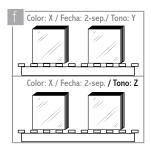
Agrupe las cajas de acuerdo a su tono, lote y fecha de fabricación. Compare visualmente las piezas para verificar la uniformidad de su superficie. Este proceso debe realizarse en exteriores y a la luz solar. Si instala referencias rústicas combínelas para establecer homogeneidad en las vetas o los diseños.
