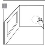
Antes de iniciar la instalación, limpie la superfície de soporte para eliminar el polvo y los residuos de obra. Estos restan adherencia al mortero de pega.
