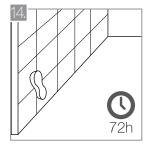
El endurecimiento de la boquilla toma 72 horas. Limpie las paredes después de este periodo con una esponja humedecida en agua. Evite los productos ácidos.
