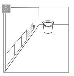
Esparza mortero de pega sobre un área equivalente a de la pieza y cree surcos con la llana dentada. En formatos superiores a los 33 x 33 cms., repita el procedimiento en la cara oculta de la pieza. Adhiera el gres porcelánico inmediatamente, ya que la exposición del pegamento al ambiente puede restar sus propiedades de adherencia.
