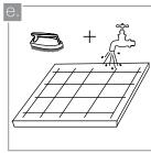
Limpie la cara oculta de cada gres porcelánico con un cepillo suave y agua limpia hasta retirar el polvillo remanente. Deje que la pieza seque totalmente y guárdela en su caja hasta el momento de la instalación. No omita este paso, ya que podría reducir la adherencia del mortero.
