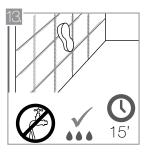
Limpie los excesos de boquilla con una esponja humedecida en agua limpia inmediatamente. No omita este paso, pues el contacto con el material de rejuntado por más de 15 minutos ocasiona daños irreparables en la superficie del gres porcelánico.
