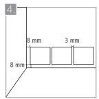
Mantenga una distancia mínima de 3 mm. entre las piezas y una junta perimetral de 8 mm. con respecto a los muros para prevenir un desprendimiento futuro del producto. En áreas extensas, instale los pisos en secciones de máximo 30 m2, dejando dilataciones perimetrales entre ellas. Si la superficie tiene juntas estructurales debe respetarlas. Recomendamos el uso de Sikaflex 1CSL o 1A para el llenado de estos espacios.
