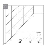
Elija el material de rejuntado que más se aproxime al color de su gres porcelánico y prepárelo siguiendo las instrucciones del fabricante. Recomendamos el uso de Durapega Boquilla Látex Porcelánico. No utilice boquillas color 'negro humo' ni añada grafito a la mezcla de las mismas, ya que esto puede ocasionar manchado del producto.
