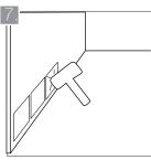
Adhiera cada pieza presionando levemente hacia abajo girándola un poco hacia los lados. Golpecon el martillo de goma para evacuar restos de aire presentes en el material de pega. El uso de anclajes puede ser requerido.
