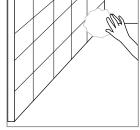
Limpie las juntas entre las piezas con una solución específicamente formulada para tal fin. Recomendamos el uso de Fuganet (Cod. FIS6NR013).
