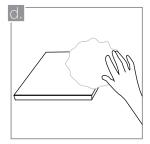
Algunas piezas de gres porcelánico pulidos poseen una capa grasa que los protege durante el transporte. Dicha capa debe retirarse antes de iniciar la instalación, frotando cemento blanco con una estopa sobre las piezas claras, y detergente neutro sobre las oscuras.
