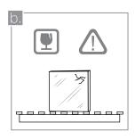
Todas las piezas de gres porcelánico requieren un manejo cuidadoso durante su almacenaje, manipulación e instalación para evitar despuntados, astillado en los bordes o rayado de la superficie.
