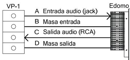
Las conexiones se realizarán mediante dos cables proporcionados con el módulo VP-1. Si la longitud de éstos no fuese suficiente para su proyecto, pueden suministrarse bajo pedido unos con la medida adecuada. La conexión al panel trasero de Edomo se efectuará atendiendo a la siguiente imagen:
