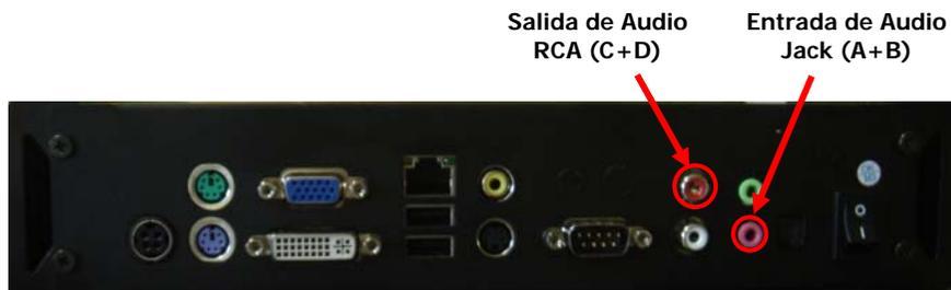
La **entrada** de audio se realiza mediante un jack mono de 3,5 mm insertado en el conector de color rosa de Edomo.
