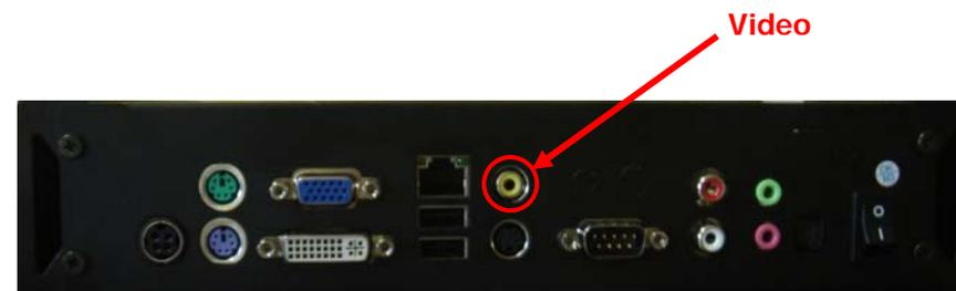
La señal de vídeo debe ser compuesto de 1 Vpp de amplitud sobre una impedancia de 75  $\Omega$  y ancho de banda 5 MHz.
