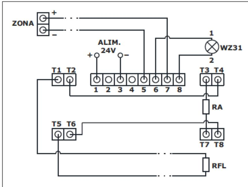
Fig. 6 Conexión de un detector a una línea de zona convencional.
