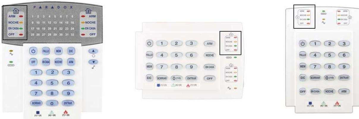
Cada vez que se pulsa **[ENTRAR]**, el teclado muestra el dígito siguiente de la sección en curso y continua a través de las siguientes secciones un dígito a la vez sin cambiar los valores programados. No está disponible para las secciones que usan el Método de Selección de Funciones Múltiples. Pulsar la tecla **[BORRAR]** en cualquier momento para salir del Modo de Pantalla de Datos.
