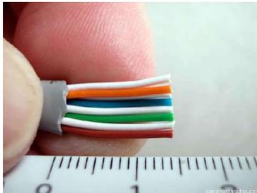
Insertar los hilos en el conector y engastar
