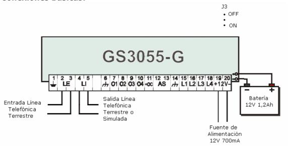
Conecte la entrada de línea telefónica a los terminales LE.
