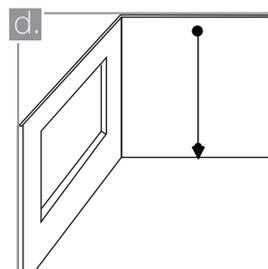
Verifique que el área a recubrir esté totalmente curada y que no presente filtraciones de humedad. Las diferencias de planeidad mayores a los 3 mm. de profundidad por metro lineal deben corregirse.
