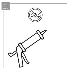
Debido a su composición orgánica, los mosaicos de Bamboo deben ser adheridos a la superficie de soporte con pegamentos especiales para madera que no tengan base agua en su formulación. Recomendamos el uso de Sikaflex 1A o de Sikabond AT universal.
