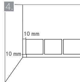
4. Mantenga una junta perimetral de 10 mm. y una junta de dilatación equivalente a la distancia entre los recuadros de madera. Si la superficie a recubrir tiene juntas estructurales debe respetarlas.
