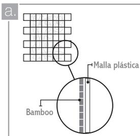
Los mosaicos de Bamboo son todos aquellos que tienen recuadros de dicha planta, unidos mediante una malla plástica en su cara posterior. Los mosaicos con reverso de cartón rígido no hacen parte de esta clasificación y deben ser instalados según el manual diseñado para tal fin.
