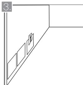
3. Aplique el pegamento seleccionado en el reverso de todos los recuadros siguiendo las instrucciones del fabricante. Ubique el paño de mosaico en la pared y asíntelo con la llana de madera para evacuar posibles bolsas de aire que puedan impedir un pegado eficiente.
