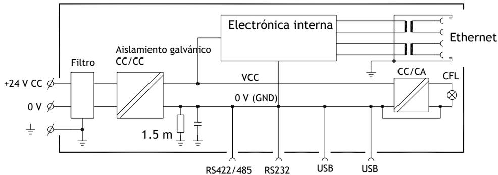
El panel de operador tiene un aislamiento galvánico contra la alimentación de 24 V, pero no existe ningún aislamiento entre los puertos de comunicaciones de RS232, RS422/485 y USB. Solamente la conexión Ethernet tiene aislamiento galvánico.
