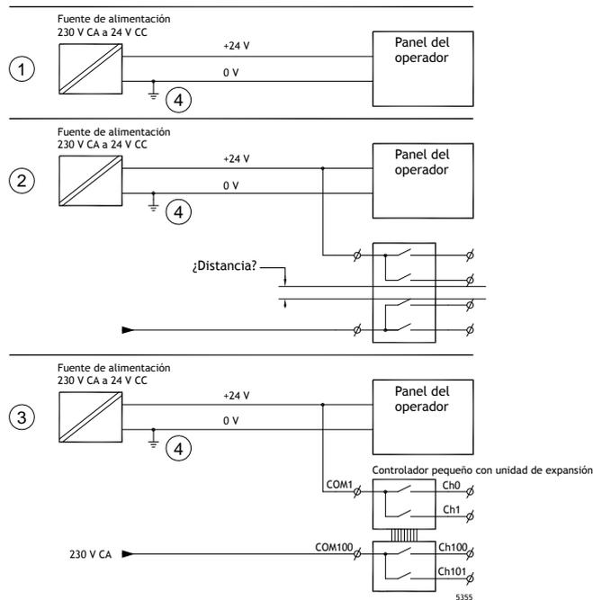
Si se utiliza una fuente de alimentación que cumpla con las normas de seguridad y sólo se utiliza para alimentar el panel de operador, no surgirá ningún problema. Véase el nº 1 en el esquema anterior.
