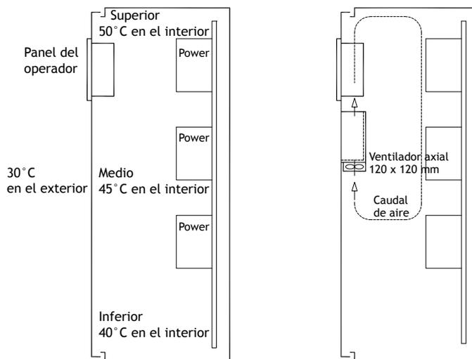
En la mayoría de los casos, la temperatura ambiente del panel de operador es ligeramente superior que la temperatura ambiente del armario del dispositivo.
