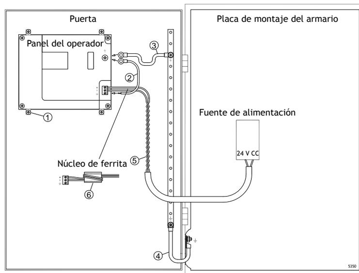
Las abrazaderas de montaje de panel del operador no proporcionan una conexión a tierra segura entre el panel y el armario del dispositivo; consulte 1 en el dibujo anterior.
