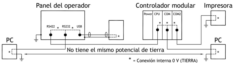
Cuando se conecta un PC a panel del operador, la conexión interna de 0V (TIERRA) del panel se conecta a la puesta a tierra protectora a través del PC.
