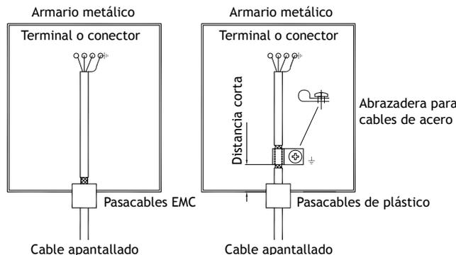
1. Utilice un pasacables EMC o un pasacables de plástico normal, retire la cubierta exterior y conecte el apantallado a la placa de instalación con una abrazadera metálica para cables de 360°.
