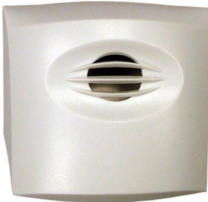
El módulo resonador ISM-BLA1-SM Blue Line se monta sobre detectores Blue Line, pero su supervisión y control completos se llevan a cabo desde el panel de control. Si se activa, el resonador emite un tono alto hasta que se silencia desde el panel de control.
