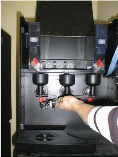
Extraiga los tubos de silicona de salida del producto y los soportes de los tubos de erogación del producto.
