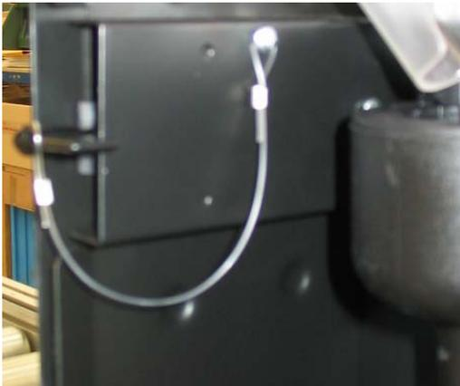
En el distribuidor existe un interruptor de seguridad que corta la tensión de todos los componentes eléctricos y electrónicos del distribuidor cuando se abre la puerta.
