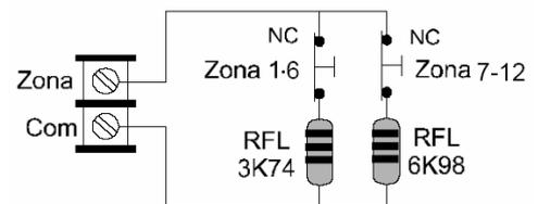
Lógicamente, en las 4 zonas de la Central NX-4 la Duplicación de Zonas, no es compatible con la función de Tamper Propio Identificado. Sin embargo, puede aplicarse la Duplicación de Zonas a las 4 zonas de la Central NX-4.
