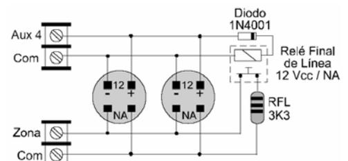
tensión de alimentación de los detectores de incendio debe permitirles funcionar a 12 voltios. El relé de alarma debe ser normal abierto. La central detectará el corte del cable de zona como avería. Si también desea supervisar el cable de alimentación coloque un relé final de línea, tal como se indica en el dibujo.
