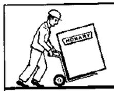
Cuando sea posible el molino debe transportarse con el empaque hasta el lugar donde va a instalarse para evitar daños. No use un cuchillo filoso para cortar la caja ya que puede dañar el equipo. Revise si hubo algún daño por el envío. Si el molino está dañando, guarde el empaque y llame a la oficina de ventas de Hobart.
