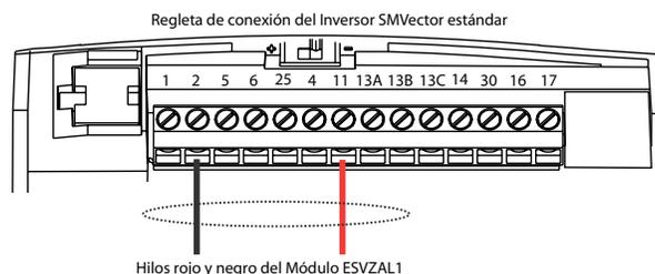
Figura 2c: Cableado del Módulo de E/S ESVZAL1
