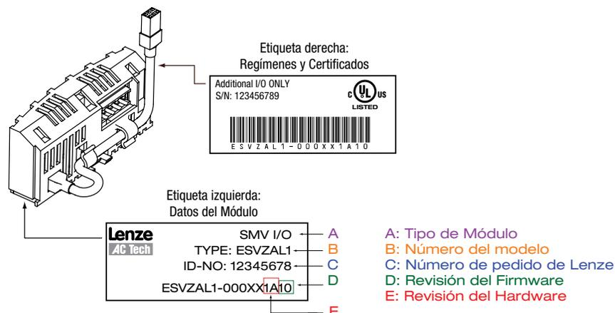
Figura 1: Etiqueta del Módulo de E/S adicional
